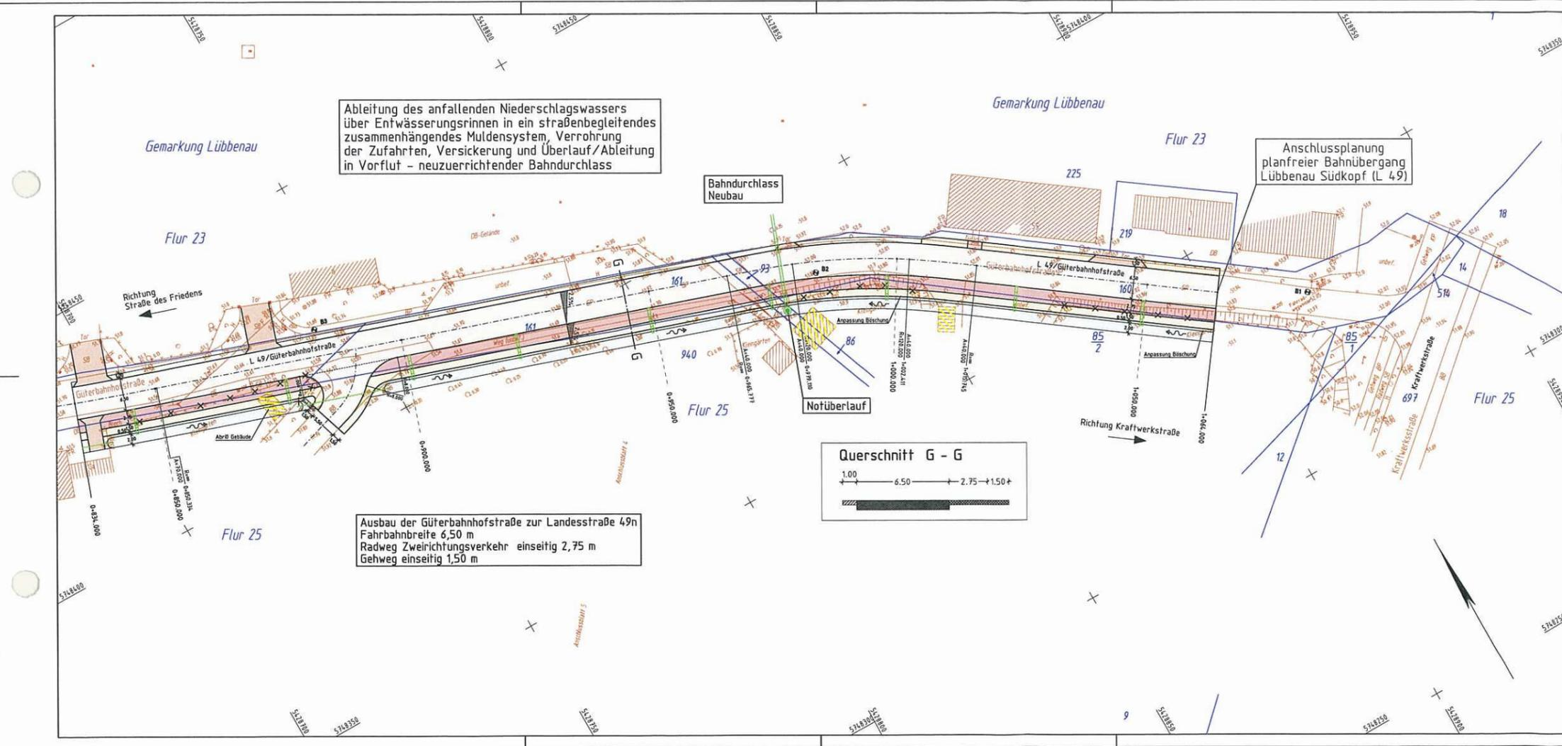
Ableitung des anfallenden Niederschlagswassers über Entwässerungsrinnen in ein straßenbegleitendes zusammenhängendes Muldensystem, Verrohrung der Zufahrten, Versickerung und Überlauf/Ableitung in Vorflut - neuerrichtender Bahndurchlass
